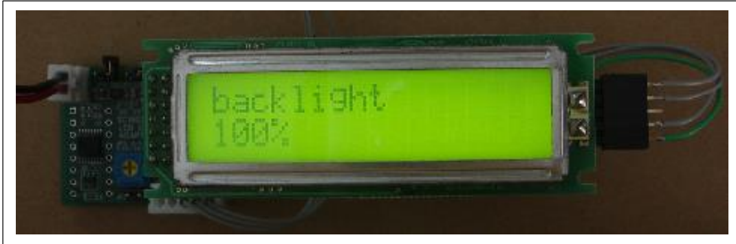
図 2-3 バックライト接続例
