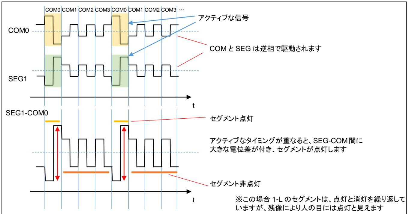
前頁のCOM0とSEG1の波形を示します。1-Lのセグメントには、COM0とSEG1の信号が接続されており、COM0とSEG1がアクティブの時は、1-Lのセグメントに大きな電位差が付くため、1-Lのセグメントは点灯します。一方、アクティブな期間が重ならない場合は、SEGとCOMには、一定の電位差しか付かない形となります。
