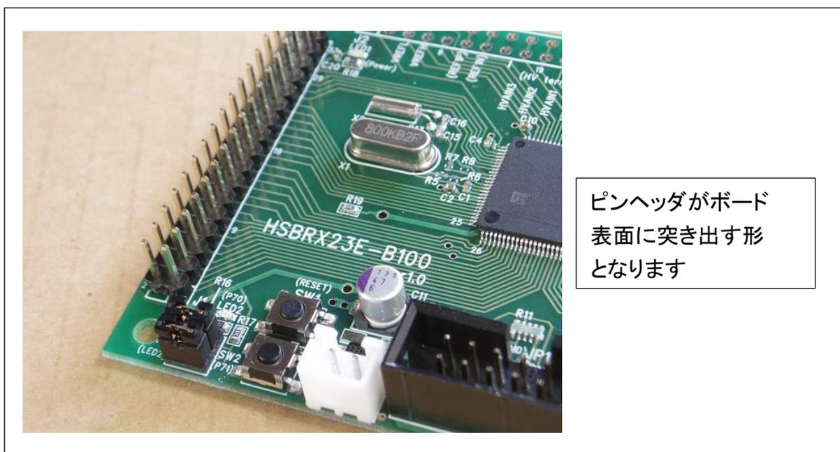
LCD ボード(HSBRX23E-B100\_LCD)は、ボード裏面がピンソケットになっていますので、ピンヘッダを実装したマイコンボードの上から被せるように接合してください。
