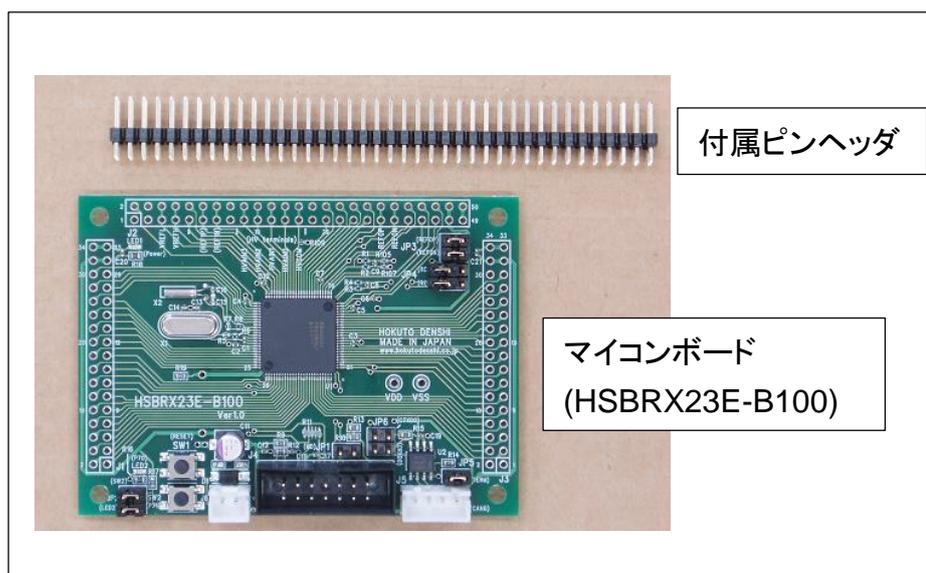
マイコンボードの J1, J3 の箇所に、カットしたピンヘッダをボード表面から挿し、ボード裏面のピンを半田付けしてください。
