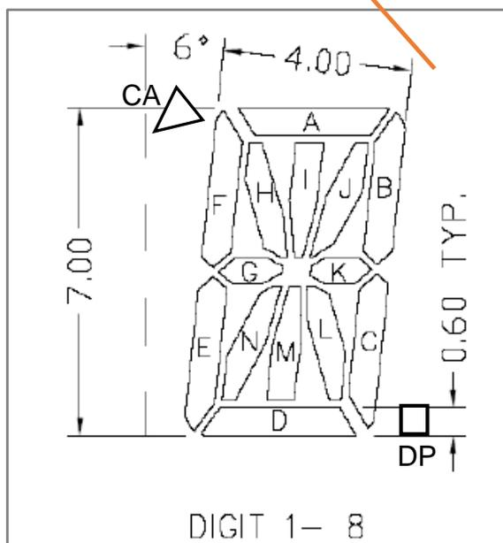
LCD の桁数は 8 桁で、1 桁あたり 14(A~N)+2(CA,DP) の 16 セグメントで構成されています。
