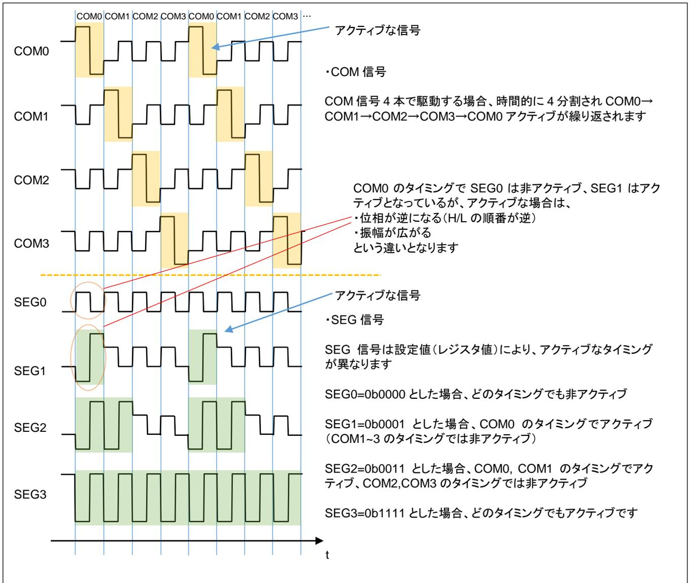
SEG0=0, SEG1=0x1(=0b0001), SEG2=0x3(=0b0011), SEG3=0xf(=0b1111)に設定した場合の波形イメージを上図に示します。
