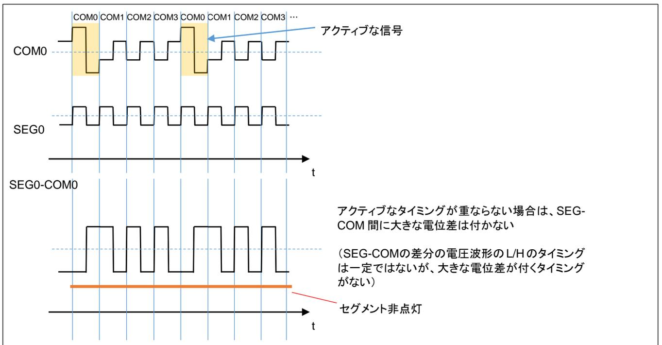
COM 信号が 4 本ある場合、液晶のセグメントに大きな電位差が付くタイミング(点灯)は、全時間の 1/4 となり、セグメントは点滅の状態となりますが残像により、人の目には点灯と認識されます。但し、SEG, COM 信号の駆動周波数によっては、点滅に見える場合もありますので、使用する液晶により周波数の調整等は必要です。
