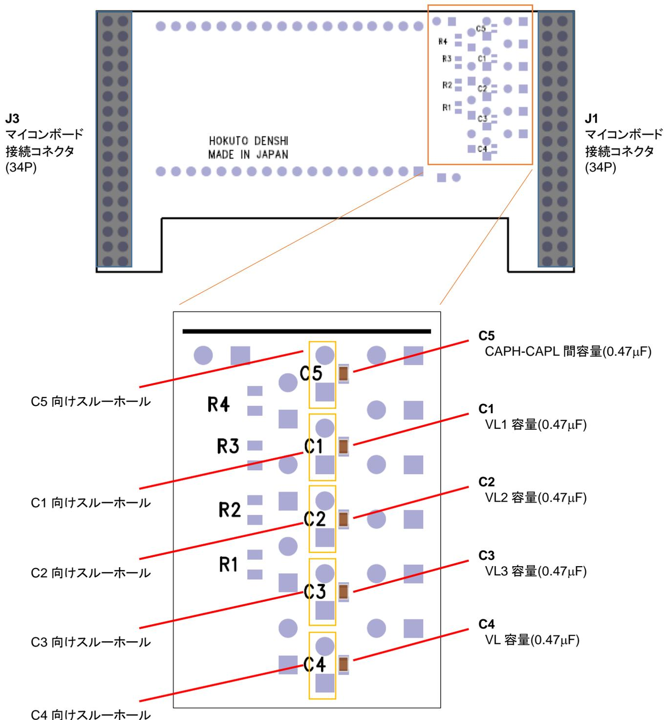
図 1-3 ボード配置図(裏面)
