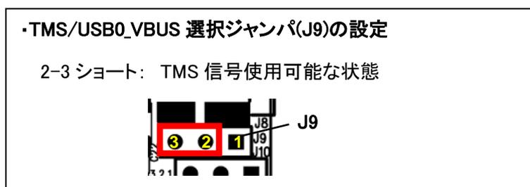
図 2-5 TMS/USB0\_VBUS ジャンパ設定図(J9)
