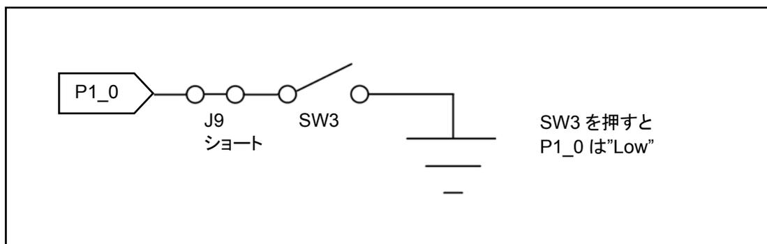
図 4.5 評価用スイッチ有効時回路
