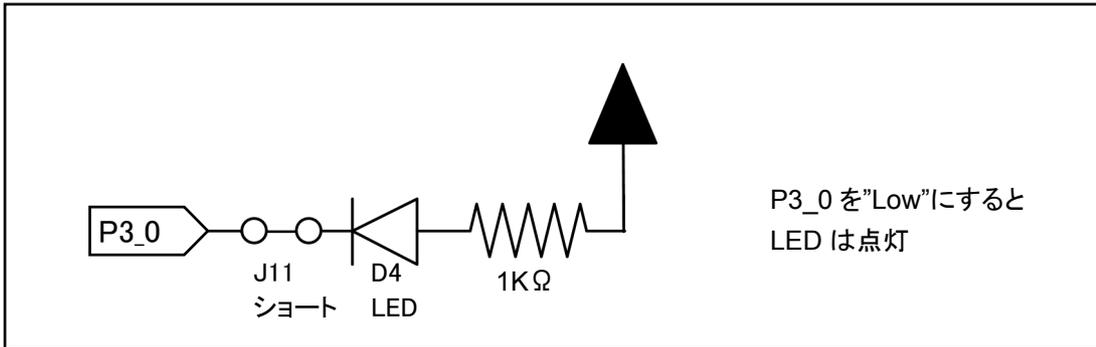
図 4.4 評価用 LED 点灯時回路
