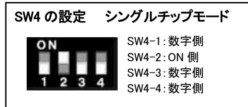
図 3-1 SW4 ジャンパ設定図1
