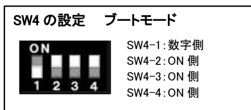
図 3-3 SW4 ジャンパ設定図2
