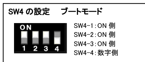
図 3-3 SW4 ジャンパ設定図2
