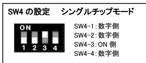
図 3-1 SW4 ジャンパ設定図1
