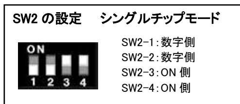
図 5-1 SW2 ジャンパ設定図1
