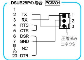
※付属の RS232C ケーブルを使って、結線図に応じたケーブルをご用意して下さい ※別売オプション品 専用 RS232C ケーブル(3P-Dsub9P-JAE)もございます
