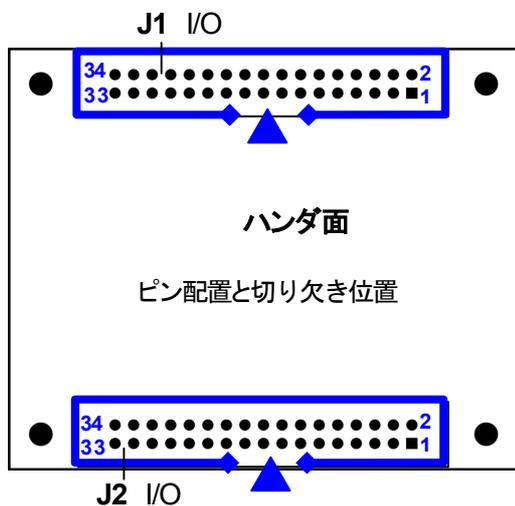
※旧製品に合わせる場合は、付属コネクタを左図の様に、コネクタの向きを合わせて、ハンダ面に実装して下さい。
