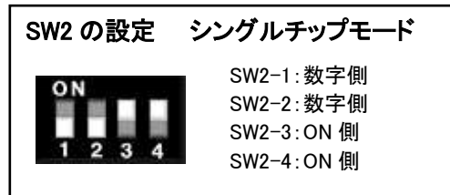
図 3-1 SW2 ジャンパ設定図1
